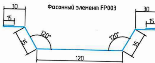
Рис.3. Узел примыкания к стальному несущему элементу
