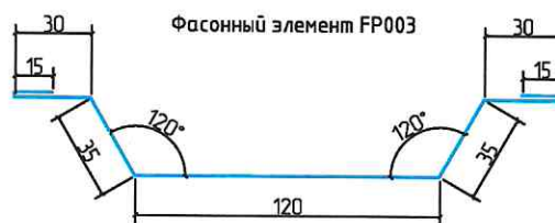
Рис.3. Узел примыкания к стальному несущему элементу
