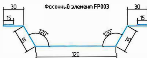
Рис.3. Узел примыкания к стальному несущему элементу
