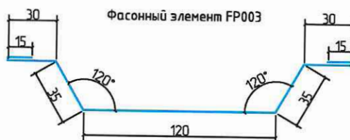
Рис.2. Узел примыкания к ж/б несущему элементу
