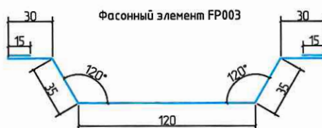
Рис.2. Узел примыкания к ж/б несущему элементу
